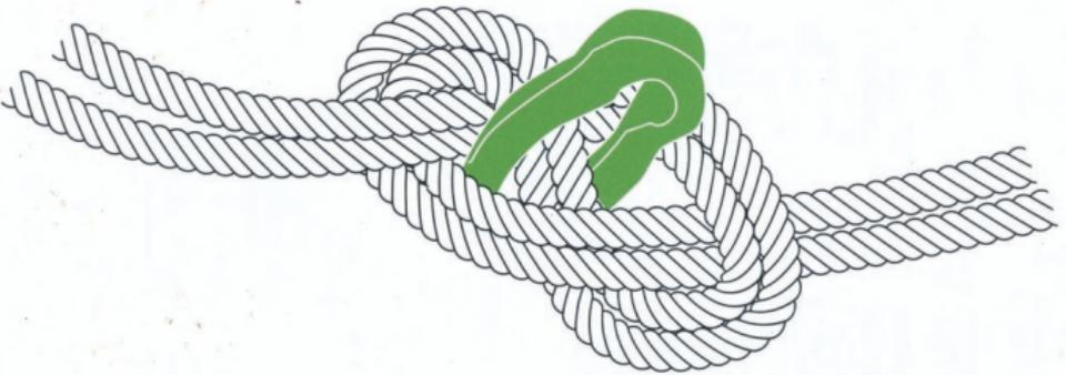
Zum Entfernen des O-Keys wird an der Unterseite etwas gedrückt und oben am O-Key gezogen. Durch den nach dem Entfernen des O-Keys entstandenen Platz lässt sich der Knoten nun leicht öffnen (ohne Abbildung).
