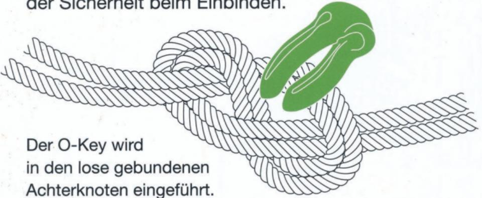
Der O-Key wird in den lose gebundenen Achterknoten eingeführt. Hierbei erfolgt die Sicherheitskontrolle des Knotens!
