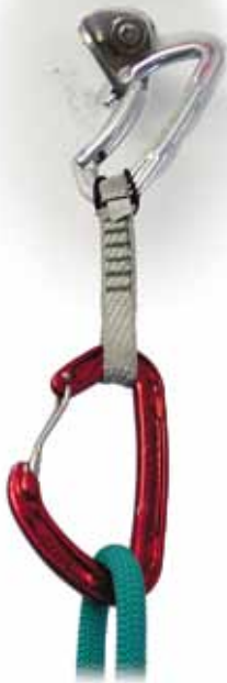
Abb. 4: Der Unfallhergang im Zillertal: Die Kerbe der Karabinernase hängt sich im Bohrhakenplättchen ein und erzeugt eine Hebelwirkung.
