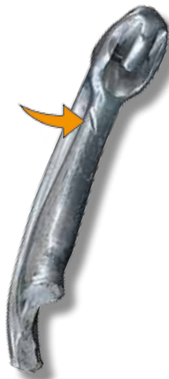
Abb. 2: Die Kerbe an der Nase zeigt, dass beim Unfallkarabiner vom Schleierwasserfall ein Hebel gewirkt und den Karabiner geschwächt hat.
