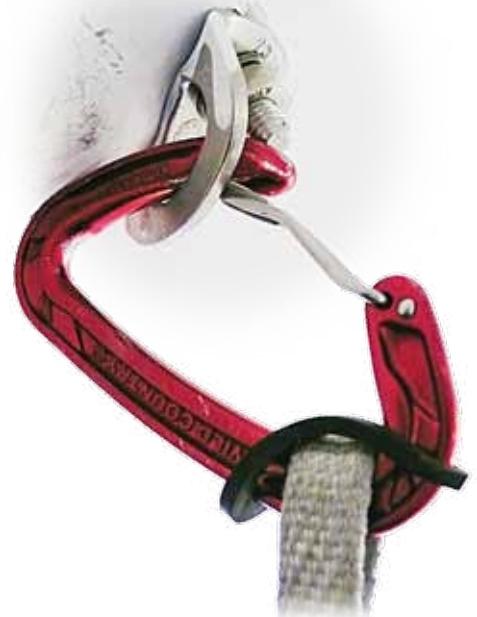
Abb. 3: Der Unfall am Schleierwasserfall: Der fixierte Karabiner wurde durch die Seilbewegung zwischen Öse und Schraube verkeantet.
